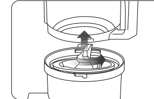
02 Tournez la poignée dans le sens antihoraire pour ouvrir le trémie automatique et séparez-la du tambour.
